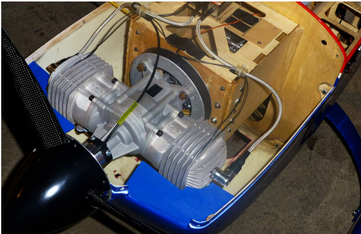
Innmontering av en to-sylindret bensinmotor på 180 cc med Hyde feste i et tradisjonelt oppbygget fly på om lag 3 meter i vingespenn.
