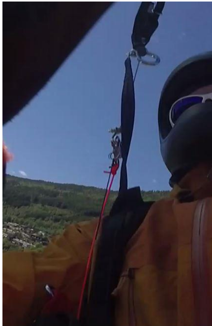
Figur 5 - Acro Base systemet er løst ut - speedbarsystemet holder igjen skjøtekrok, man ser ringen begynner å åpne seg
