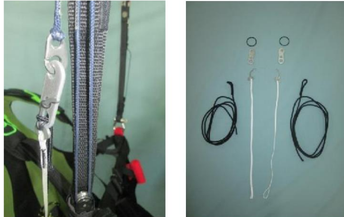
Figur 11 - Speedbar releasesystem fra AVAsport – bilde fra manual for AVAsport Acro Base seletøy
