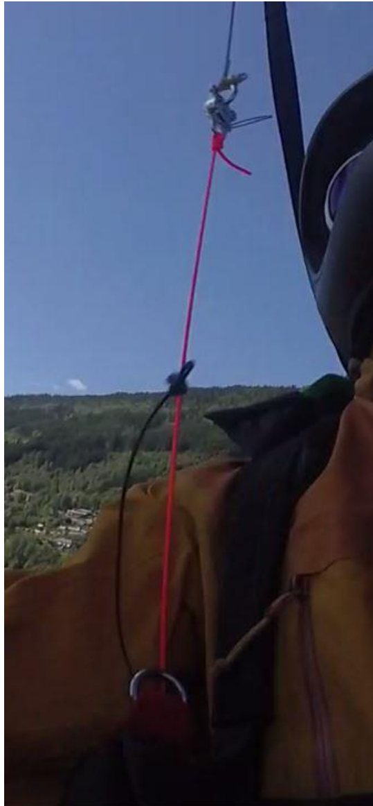
Figur 7 - Her har Dyneema-linen sluppet fra utløsermekanismen og automatiskåpning er ikke lengre mulig
