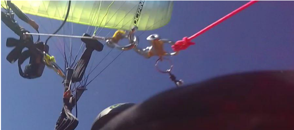
Figur 10 - Venstre side av utlørsystem for speedbar fungerte som tenkt.
