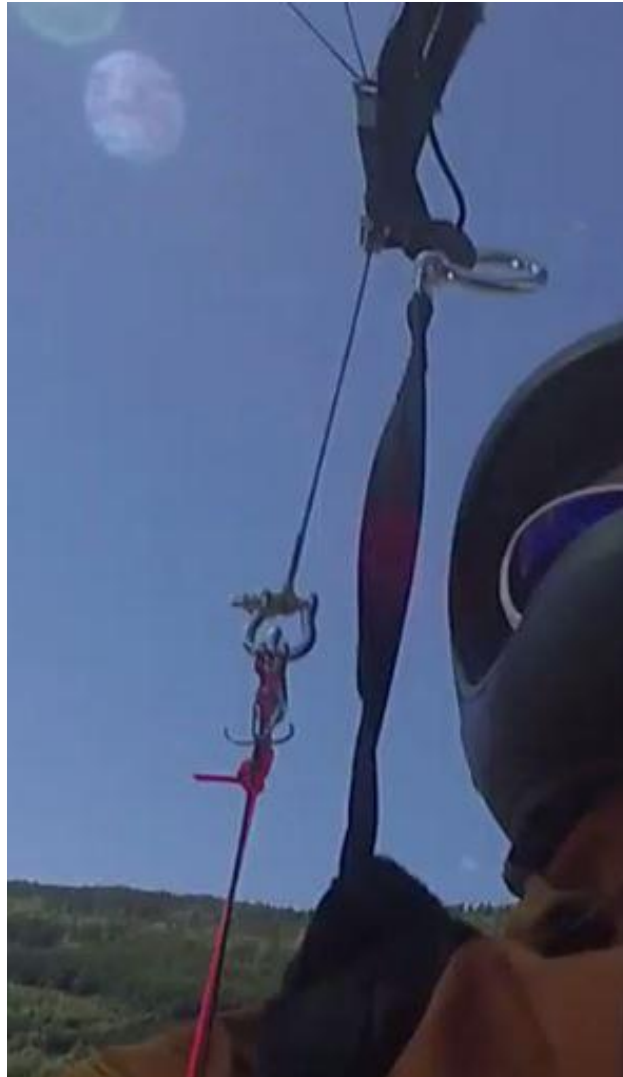
Figur 6 - Speedbarsystemet holder fortsatt igjen, man ser tydelig ringen på utløser åpner seg
