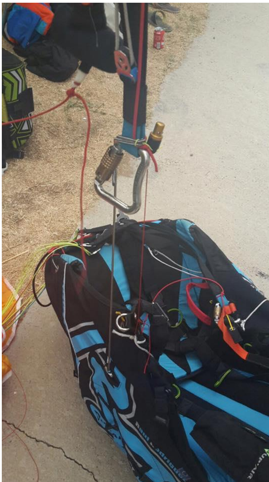
Figur 14 - TecTeam Quicky som henger fast i vingen etter å ha løst ut.
