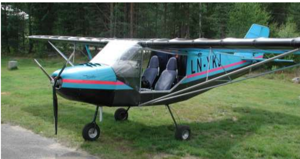
Rans S6-ES levert som byggesett fra USA og montert i Norge. En to-seter side-by-side, og motoren er en 65Hk Rotax 582 to-takter.
