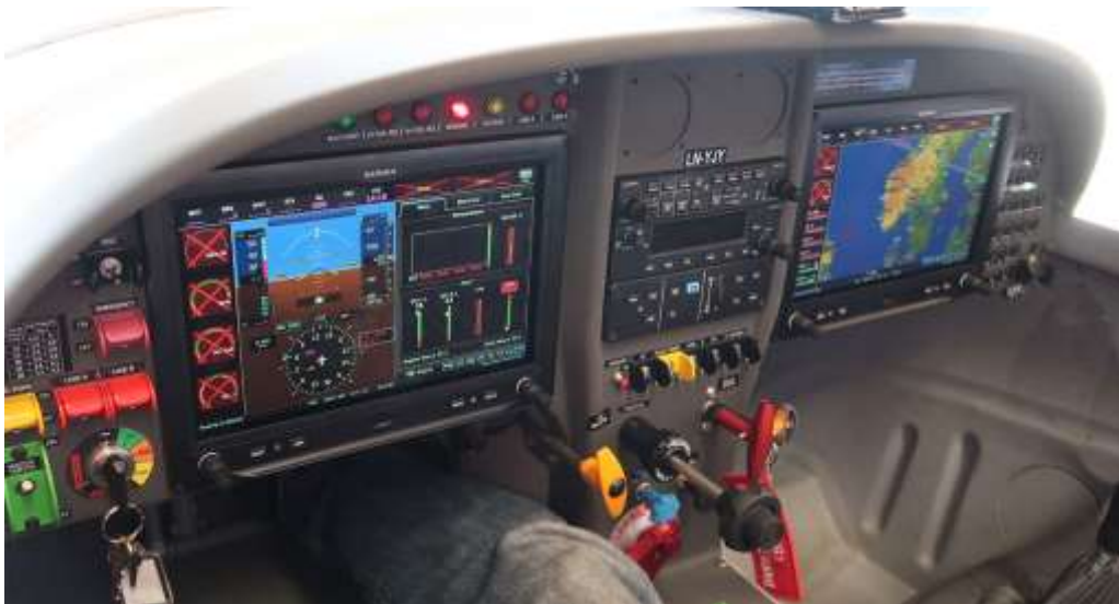
De mest moderne mikroflyene er utstyrt med "glasscockpit".
