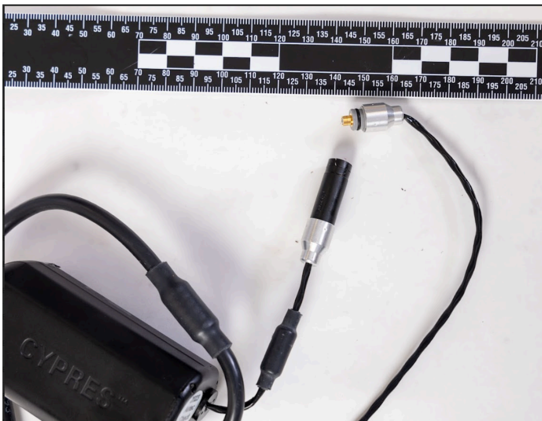
Bilde 4: Brudd i koblingen mellom hovedenhet og kutter i nødåpneren
