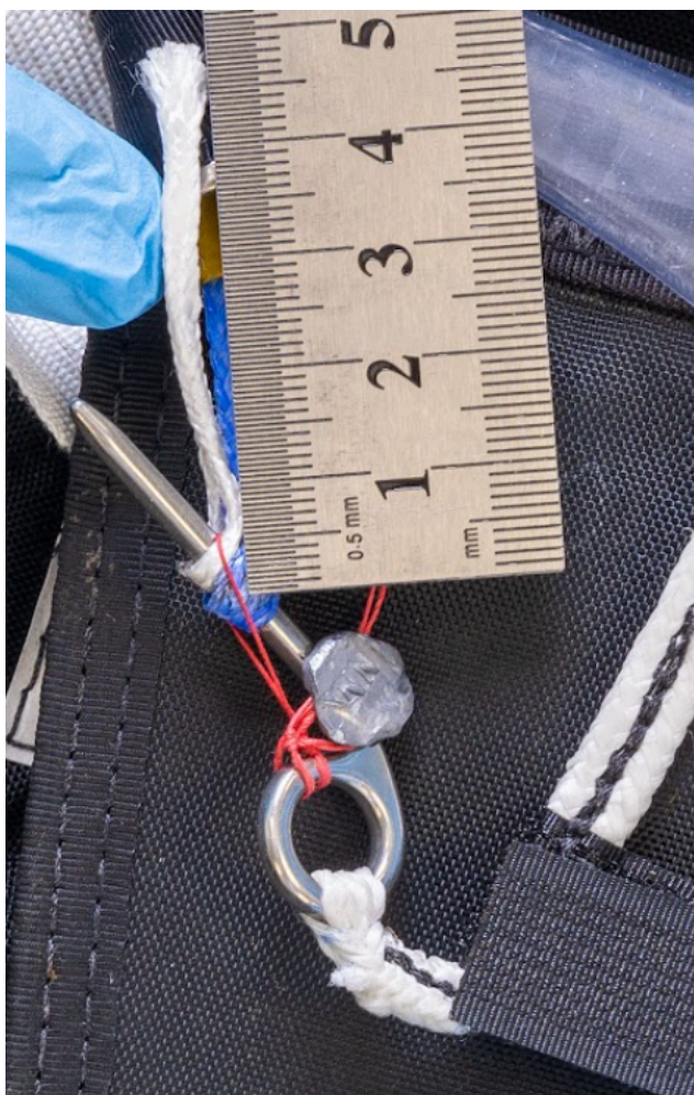
Bilde 7: Reservepinne med hel plomberingstråd og plombekode "NNY"
