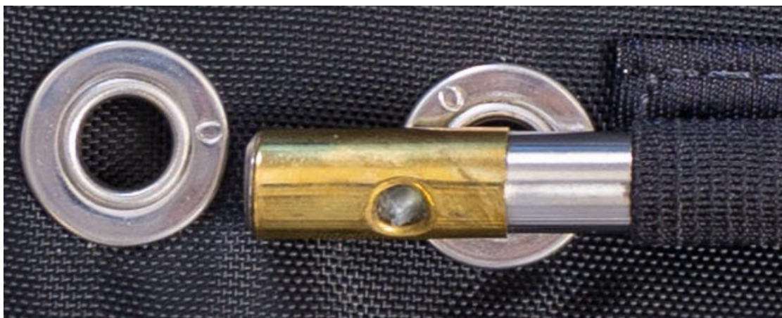
Bilde 5: Kutter har aktivert. Kniven har blitt skutt frem og lukker hullet loopen trees igjennom.
