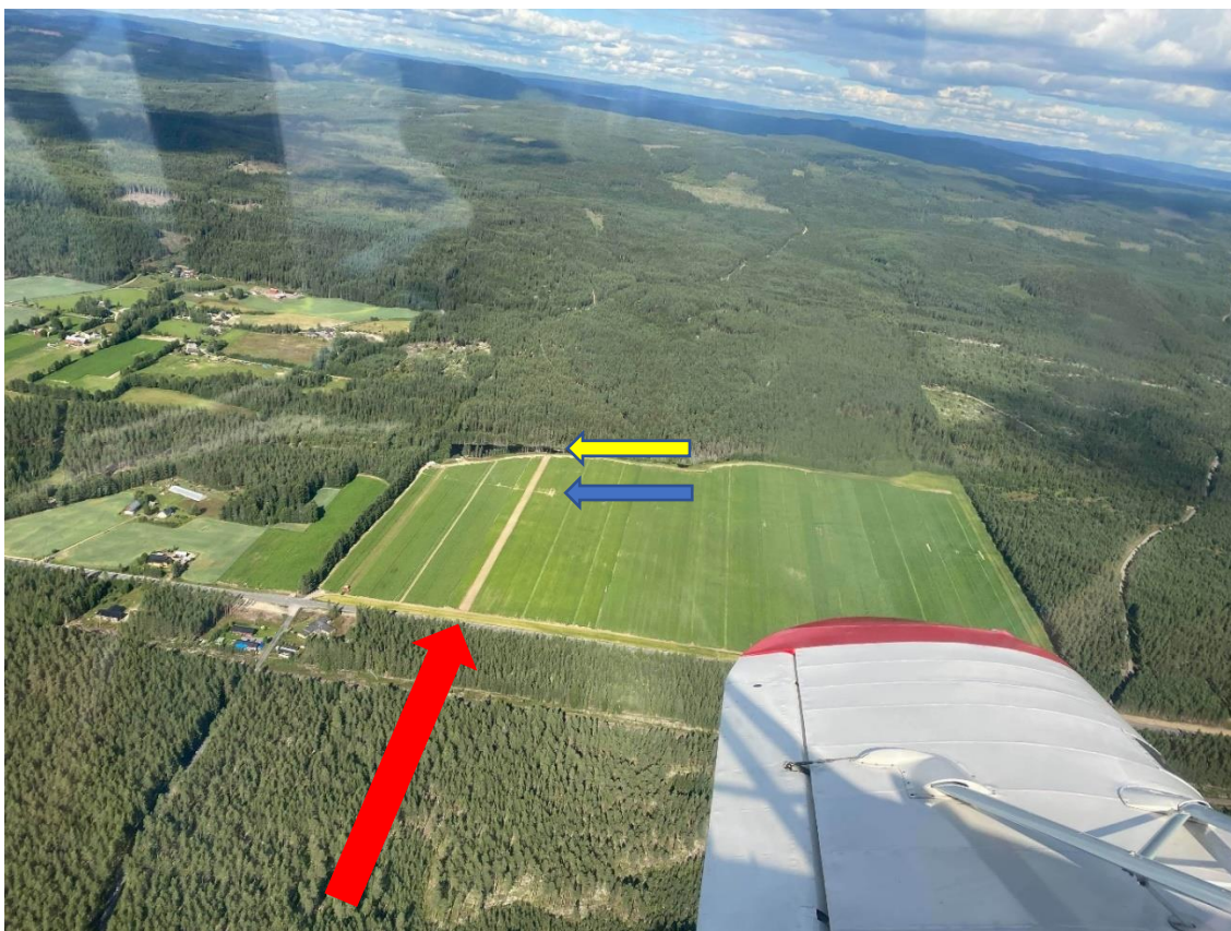
Foto 4: Flyfoto av utlandingsjordet fra havaridagen. Den røde pilen angir landingsretningen og valg av traktorveien. Jordet er ca 430m bredt og ca 700m langt. Blå pil angir første landingspunkt. Gul pil viser havaristedet.
