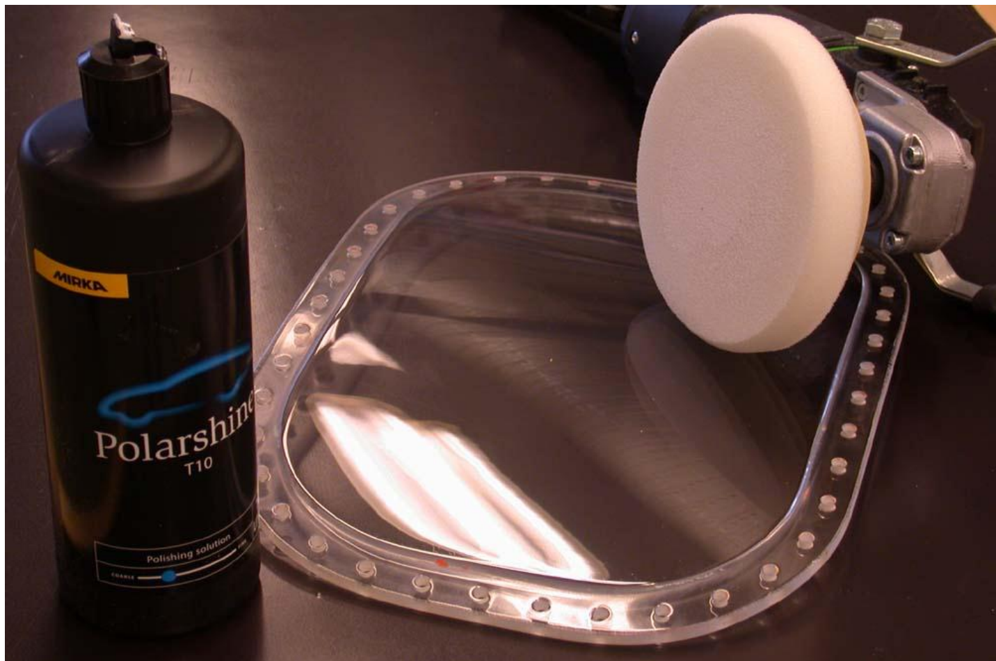
Resultat etter grov polering med T10/A12
