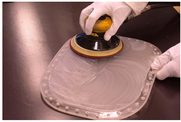
Våtslip med Mirka Abralon P 2000. Fortsett med Abralon P 4000.
