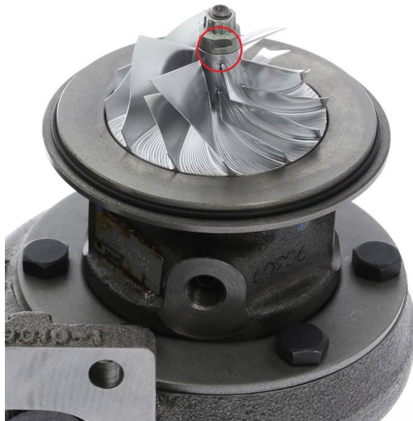
Rød ring viser «slipespor» etter balansering
