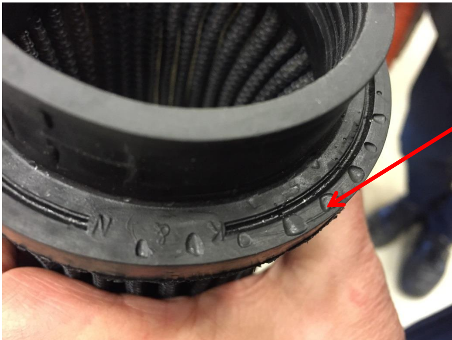
Bilde 6: Tydelige merker på luftfilterflensen etter konflikt med stoppskrue.
