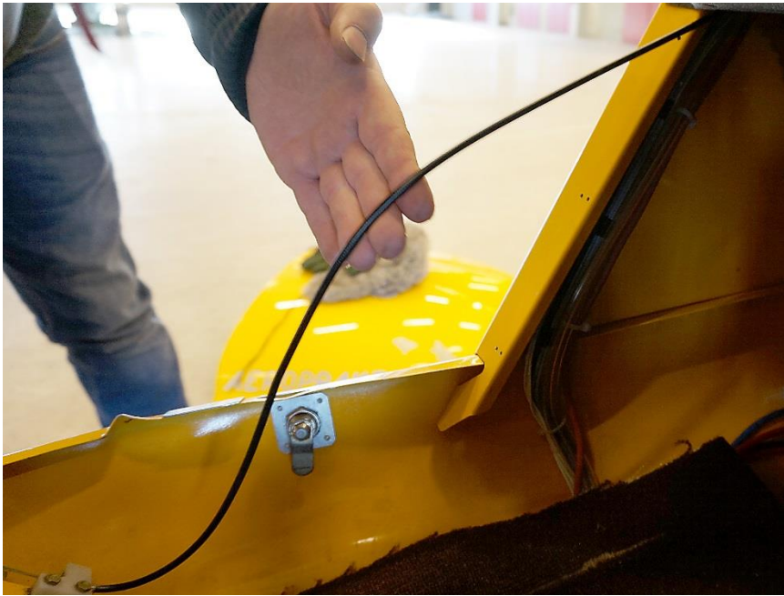
Bilde 7: Throttlewire ikke låst fast med strips til skroget.
