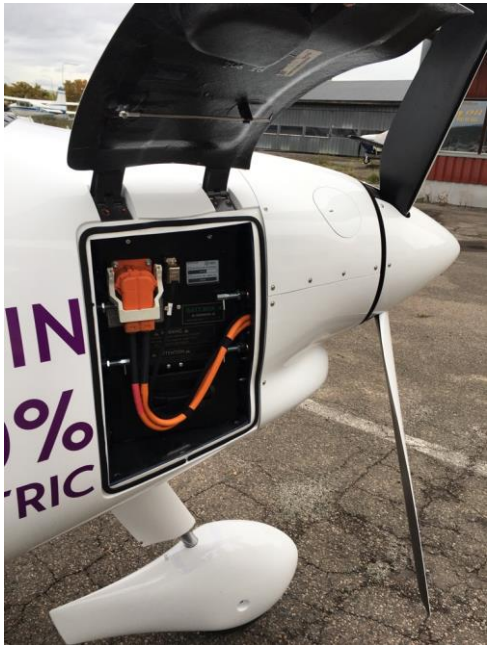
Motordeksel og batterirom for el-fly
