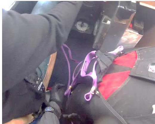
Line rundt hendel på pilotsetet. Legg også merke til unødvendig mye overskudd på lina, mellom HD-lomme og første strikk.
