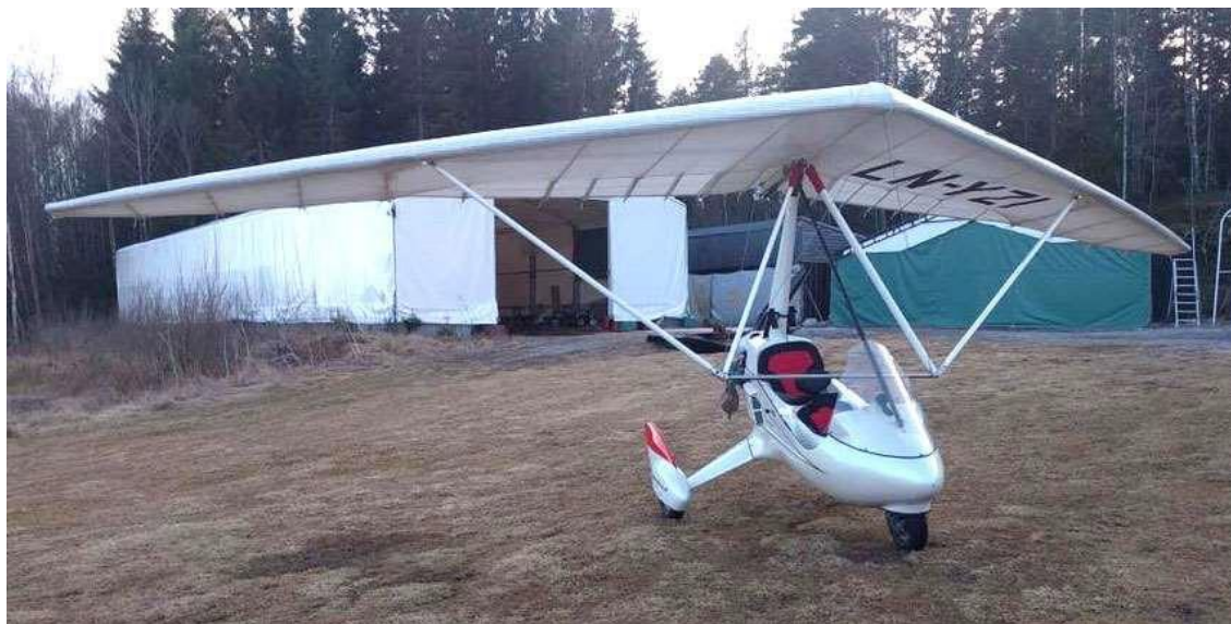
Apollo Delta Jet med Hazard 12vinge. To-seters trike med en Rotax 912 ULS fire-takts motor med 100 hestekrefter.
